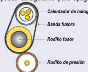
El sistema fusor de banda de vanguardia consume menos energía y reduce el tiempo de calentamiento
